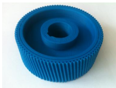
Рис. 3. Зубчатое колесо, распечатанное на 3D принтере BFB-3000 Plus
